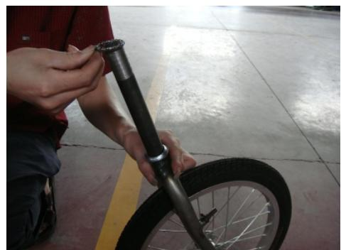
2. nasuňte věneček ložiska na vidlici kuličkami směrem nahoru a vidlici zasuňte do rámu (věneček namažte vazelinou)
