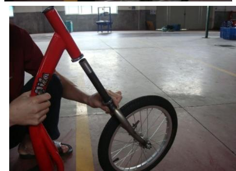
3. nasaděte vrchní věneček ložiska na vidlici kuličkami směrem dolů (věneček namažte vazelinou)
