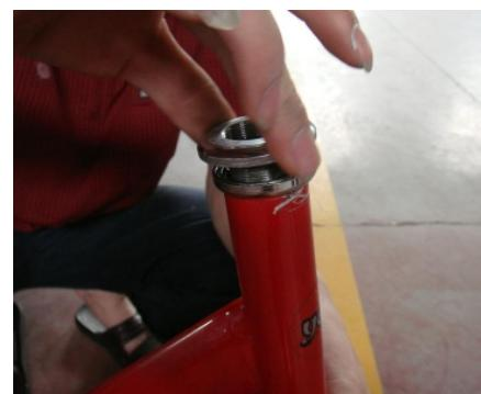
2. Schieben Sie den Kugel-Kranz auf die Gabel, mit den Kugeln in der Richtung nach oben und schieben Sie die Gabel in den Rahmen ein (schmieren Sie den Kranz mit der Vaseline).
